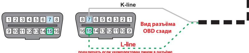
Соединение с трансмиссией в соответствии с протоколом ISO 14230 и ISO 9141 имеет сигнальные контакты в коннекторах **7** и **15** **оноционально**. К проводу, выходящему из **7-ого** коннектора припаиваем **белый** провод. **Если имеется контакт в гнезде 15**, то к проводу, выходящему из этого коннектора, припаиваем **зеленый** провод.
